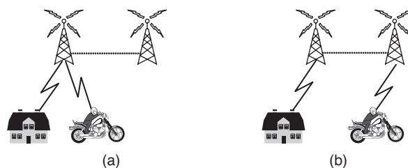
Figura 1-32. Traspaso de telefonía móvil (a) antes, (b) después.
