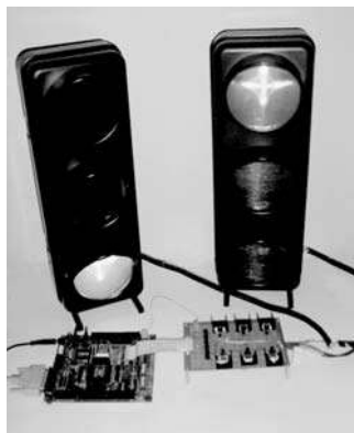
FIGURA B.1 Circuito de interfaz utilizado con las luces de los semáforos. Un circuito excita una luz.
