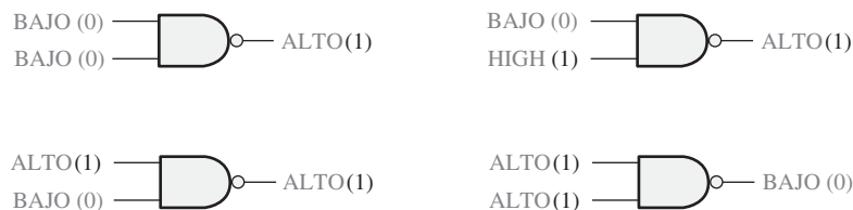
FIGURA 3.26 Funcionamiento de la puerta NAND de 2 entradas.
