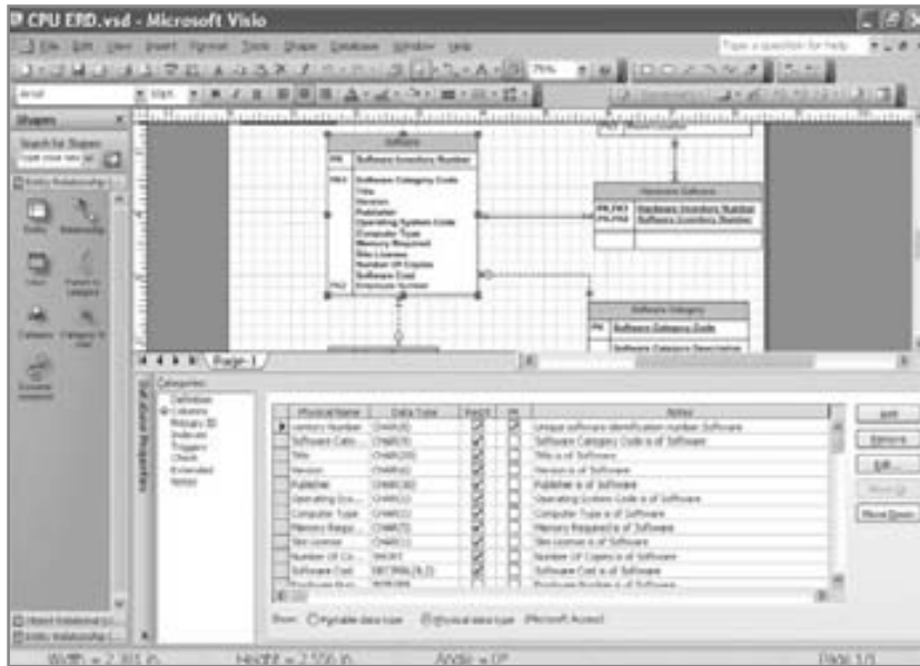
FIGURA E13.4 El diagrama de entidad-relación normalizado de la CPU se muestra en Microsoft Visio con la definición del repositorio para Software.
